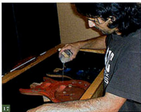
17.ドリームキャッチャー・ギターの樹脂コート流し込み。写真のレオさんは、トール・ギタースタジオ後1年ほどでマイケルの弟子となった優秀なクラフツマン。ドリームキャッチャーのアイデアは彼によるものだ。
