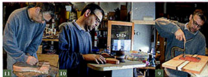
9.マホガニーとローズウッドなどの相め合わせによるボディのラミネート。 10.ボディ・シェイプも手作業で削られていく。 11.ピックアップ・ホルダーの位置決め。
