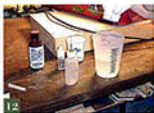
12.ボディトップに流し込まれる合成樹脂の調合。強度、パツクの外材との相性、美観性がれたときの色の置き方など、あらゆる面でギター・ボディに最適となるまでテストされたオリジナル・ミクスチャーである。
