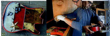
13.ボディのふちにテープ巻き付け、樹脂を流し込むため木枠にする。14.埋め込もうに細心の注意を払う。ながら樹脂が流し込まれる。15.第一段階の樹脂コートが終了したところ。
