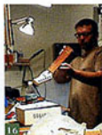
16.ネック加工。ギター作り全体で、もっとも時間を費やす細かい作業がたくさん含まれている。
